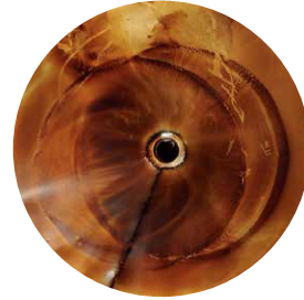
ISO VG 46 Mineral Hidrolik Yağ: 1.000 saatten sonra sonuç (500 saatte gerçekleşen ilk arıza)
